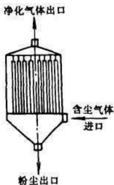
图 8.1-2 布袋收尘器工艺流程示意图
